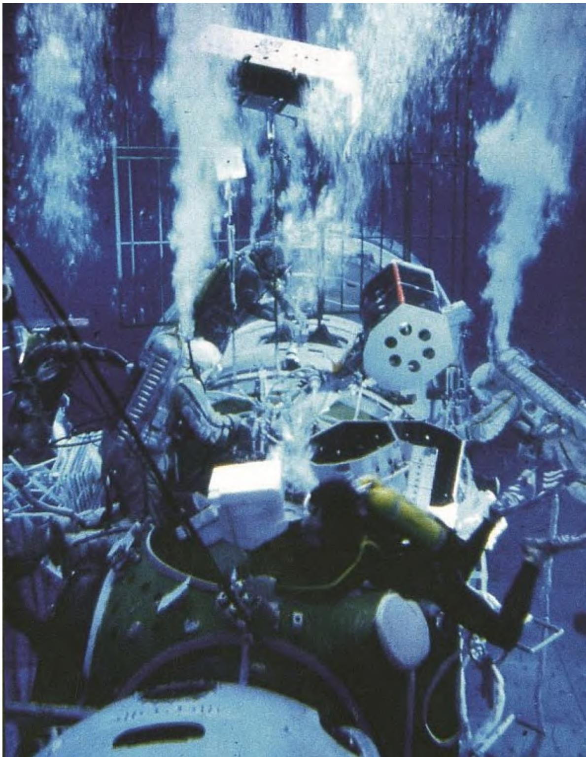
Имитация невесомости в глубоководном бассейне Центра Подготовки Космонавтов. Конечно, полезна для отработки наиболее сложных элементов внекорабельной деятельности
