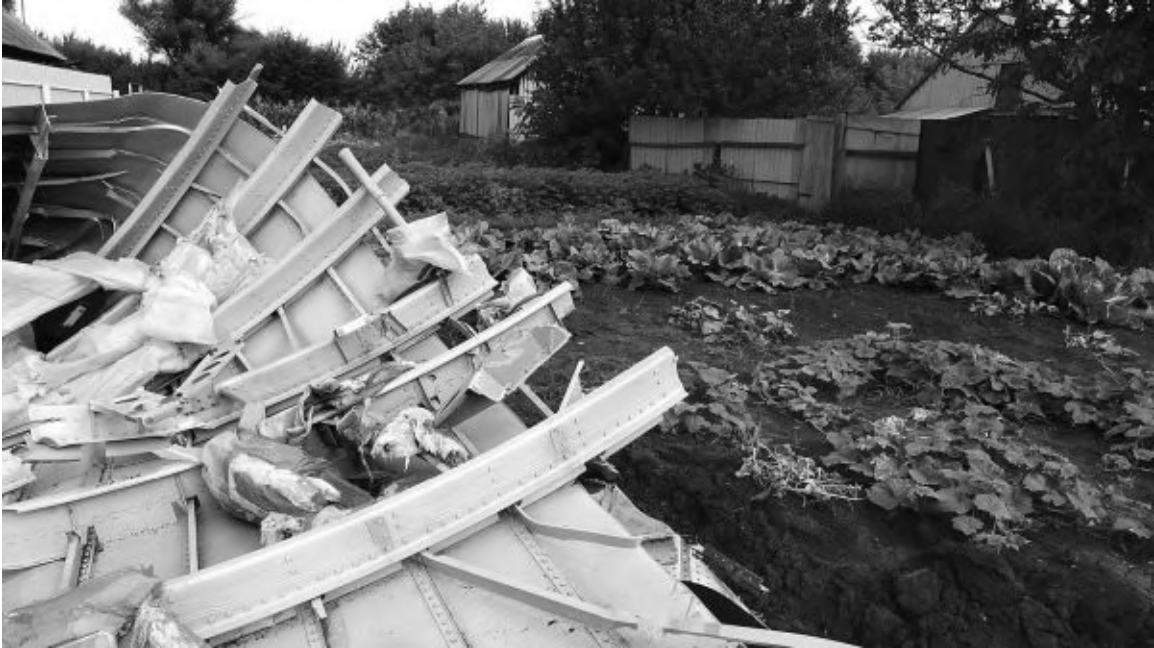
Рис. 40. Ровный обрез шпангоутов
