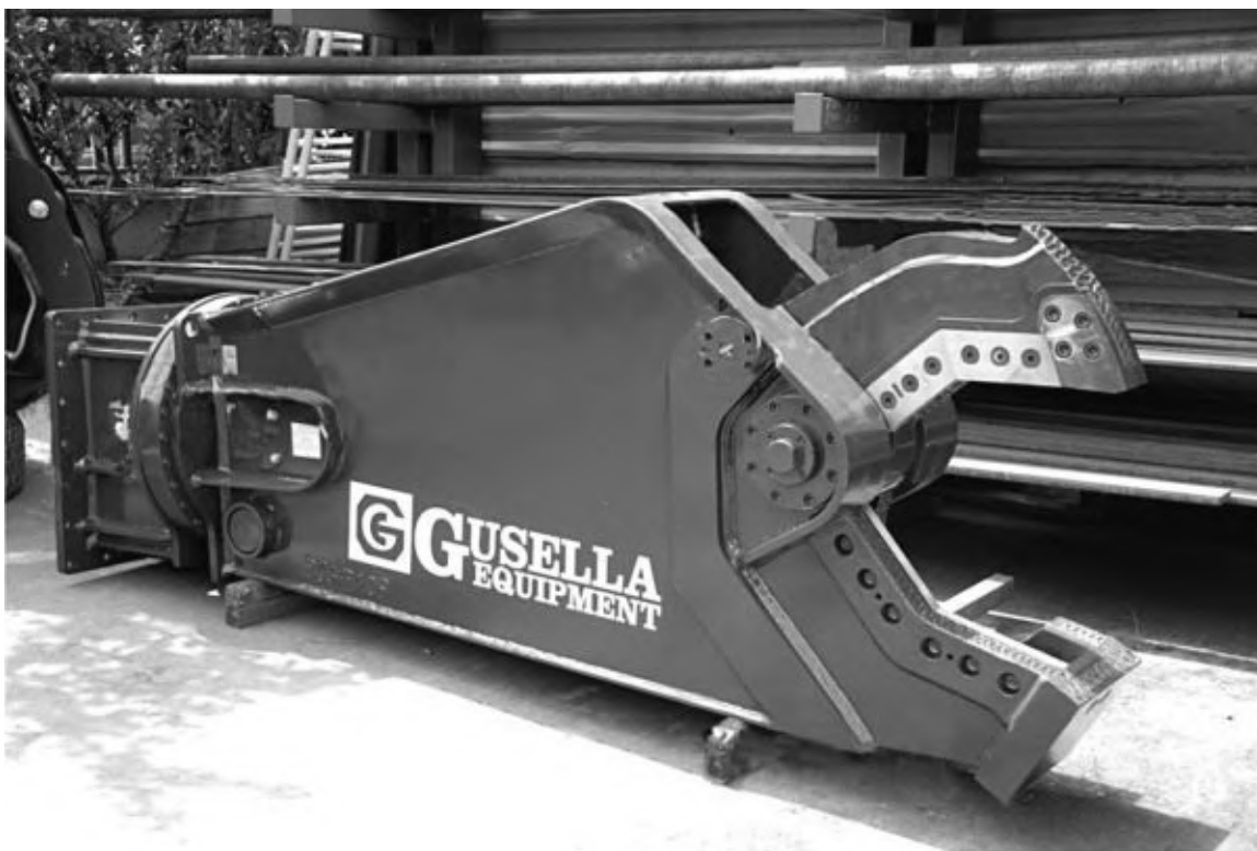
Рис. 28. Рабочий орган машины для разделки машин на металлолом — гидрожницы
