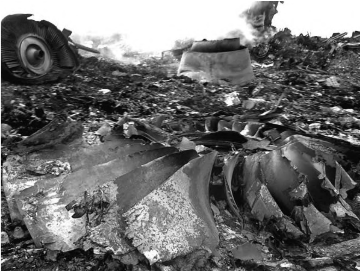
Рис. 21. Повреждения ротора вентилятора двигателя «Rolls-Royce Trent
