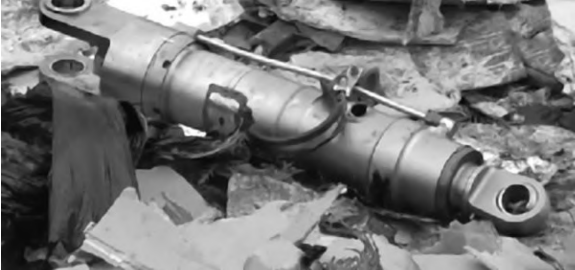
Рис. 20. Гидроцилиндр с извлеченными из проушин пальцами лежит на мелких клочках дюралюминия корпуса самолета
