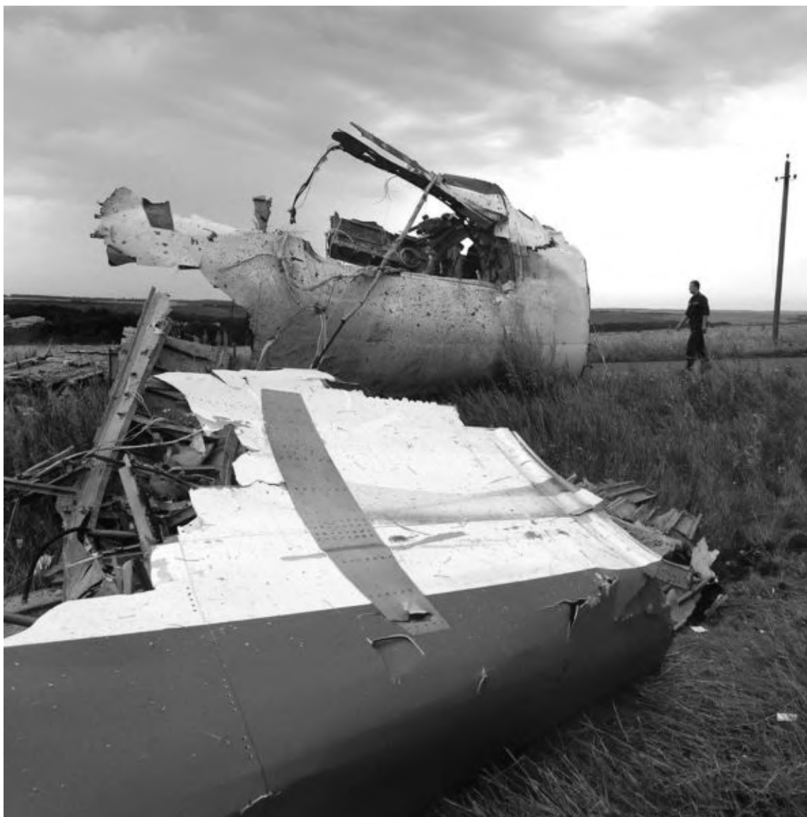
Рис. 37. Ступенеобразные «прокусы» челюстями гидроножниц — левый край, попытка захватить челюстями всю толщину конструкции — продавленный металл «п»-образной формы от давления верхней челюсти правее центра
