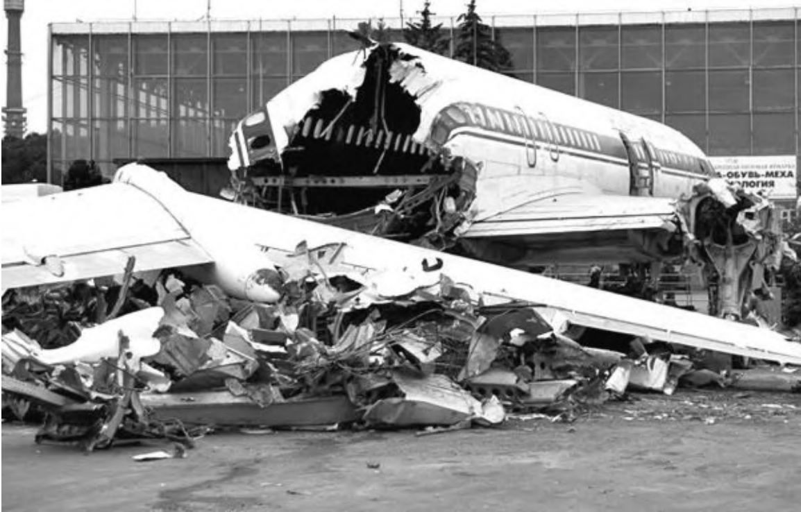
Рис. 29. Разрезка и разрывание самолета на металлолом гидронажницами
