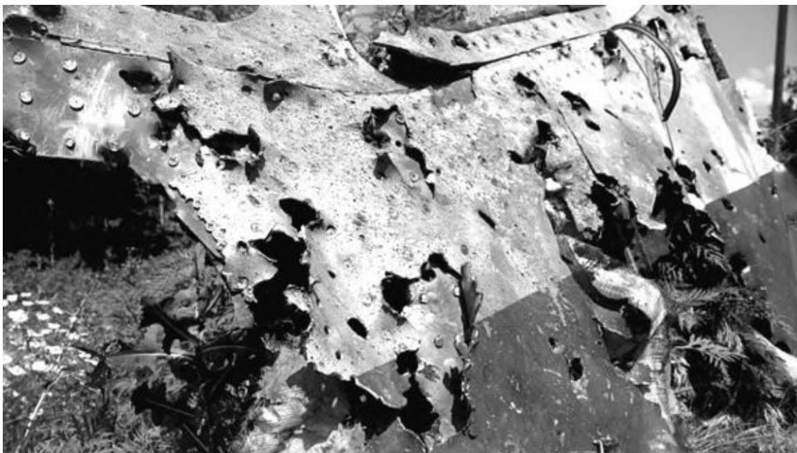
Рис. 51. Таких дыр поражающие элементы ракеты не оставляют
