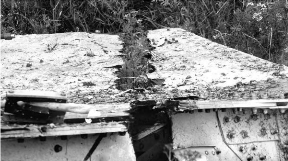
Рис. 36. Следы работы гидрорезниц на фрагментах «Боинга 777» на Донбассе
