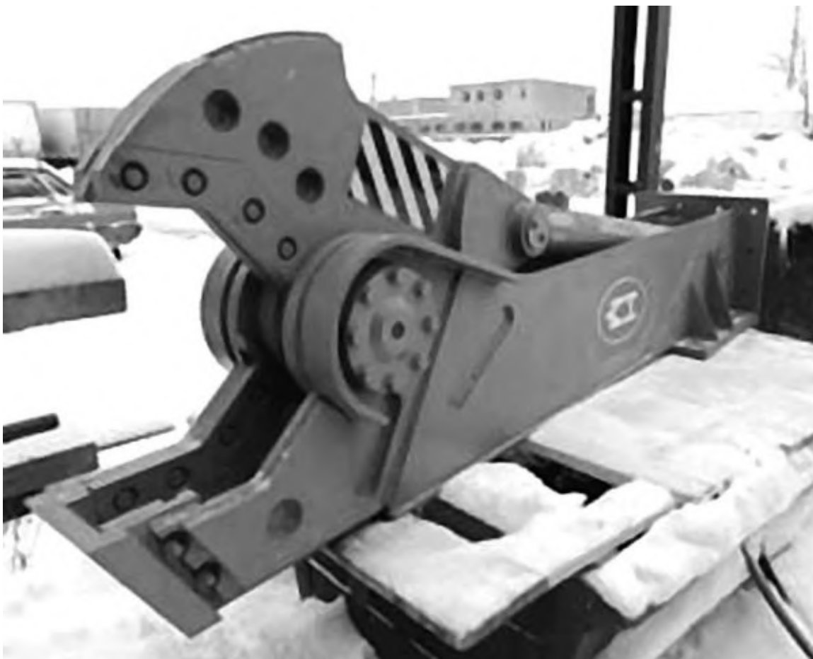
Рис. 27. Рабочий орган машины для разделки машин на металлолом — гидноножницы
